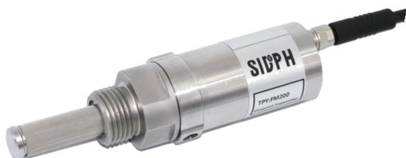
FM200露点变送器采用SIDPH自主研发的电容式阿尔法相氧化铝二氧化硅混合介质技术，适用于低露点且需要控制干点的工业环境。变送器长期高稳定，没有漂移且测量范围从 $-80^{\circ}\text{C}$ 到 $+20^{\circ}\text{C}$ ，精度高、响应迅速，灵敏度高。这使SIDPH成为一个高等级设备且维护量达到最小。
